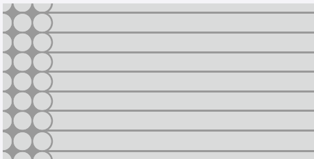
1.200 x 600 mm gerade Leitungsführung mit Umlenkkopf einseitig
